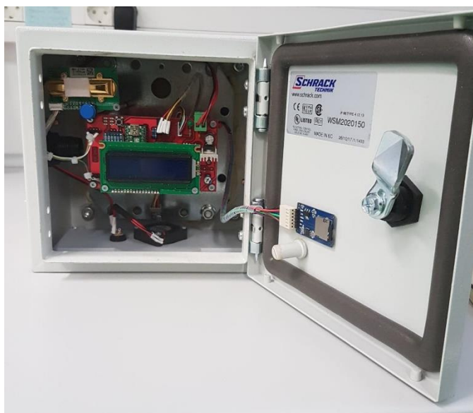
Slika 5.1 Digitalni optički senzor koncentracije lebdećih čestica na Odjelu za fiziku Sveučilišta u Rijeci.
