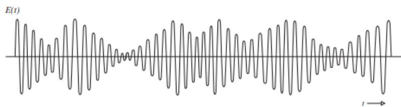
Slika 2.2. Ovisnost električnog polja kvazimonokromatske svjetlosti o vremenu. Kvazimonokromatska svjetlost čini gotovo sinusoidalan poremećaj. (preuzeto iz literature [1])
