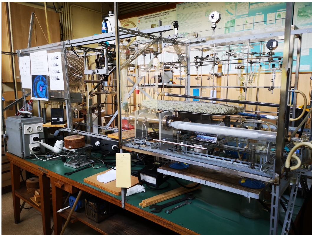
Slika 4.8: Aparatura za dobivanje CO 2 iz organskih uzoraka.
