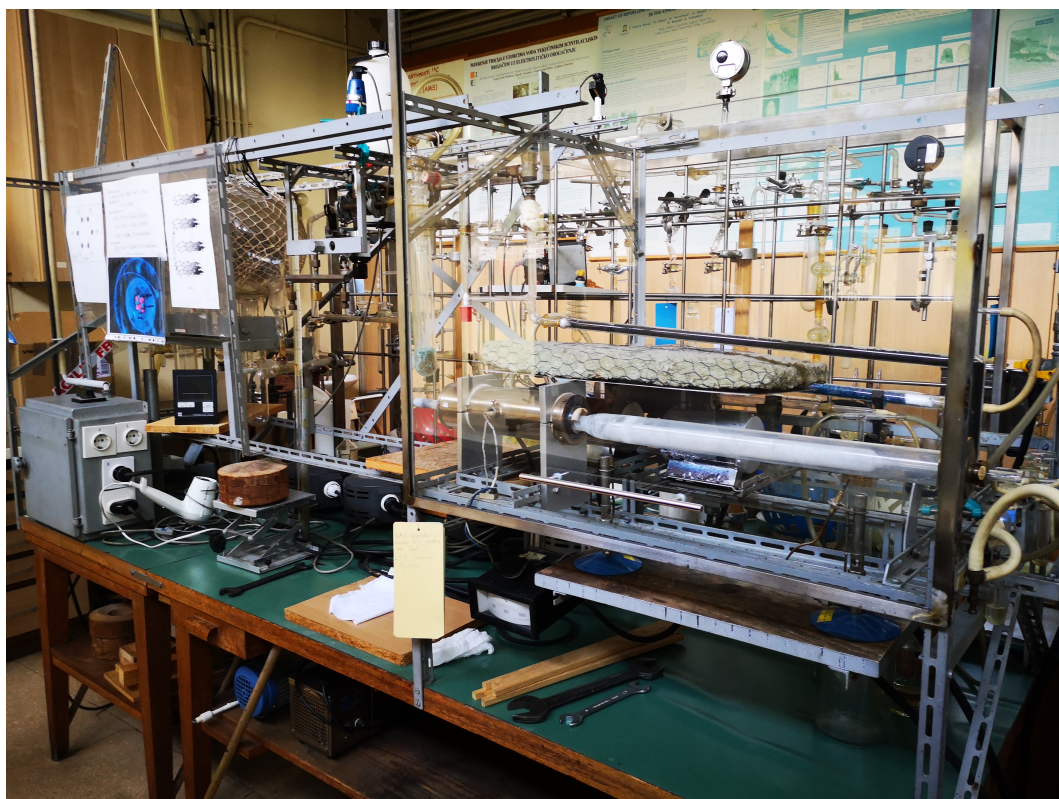
Slika 4.8: Aparatura za dobivanje CO 2 iz organskih uzoraka.
