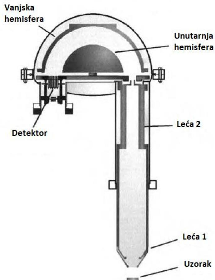
Slika 3.2. Shematski prikaz hemisferičnog analizatora energije elektrona [9].
