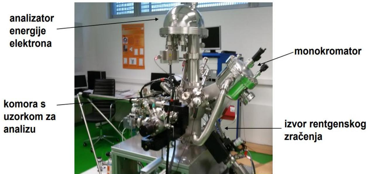
Slika 2.1. Osnovni dijelovi XPS spektrometra [3].
