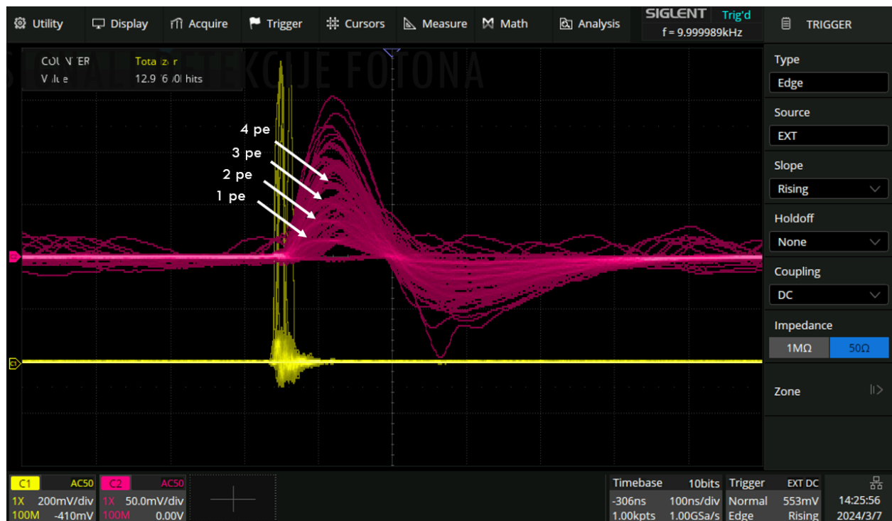
Slika 2.2: Slika osciloskopa koja prikazuje Fast output (žuta) i High gain slow shaper output (roza). Brzi izlaz pokazuje samo detekciju fotona, bez informacije o broju, dok za spori izlaz vidimo karakteristični oblik signala fotoelektrona, te su jasno vidljive razlike signala za jedan, dva, tri, četiri, itd. fotoelektrona.
