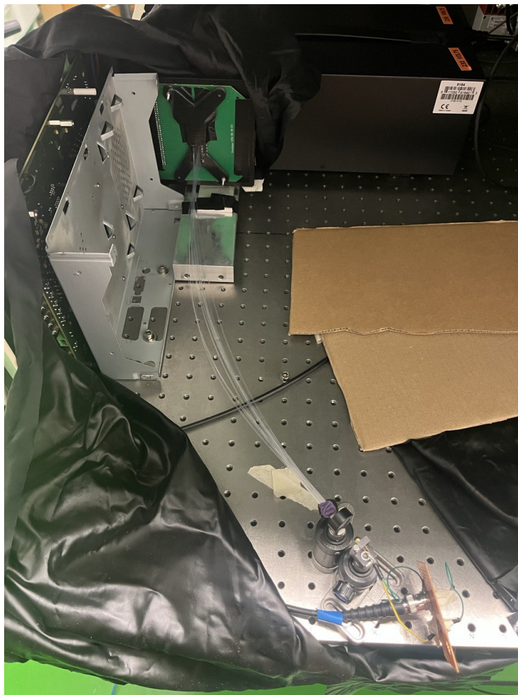
Slika 3.12: Slika postava za mjerenja sa simulacijom izvora i scintilacijskim vlaknima.
