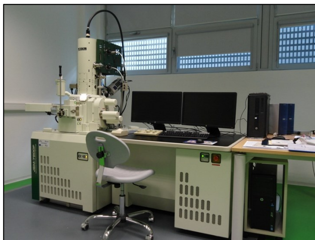
Slika 4.1. Pretražni elektronski mikroskop JEOL FEG JSM-7800F u Laboratoriju za pretražnu elektronsku mikroskopiju na Sveučilištu u Rijeci [23]
