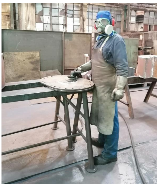
Slika 7. Brusaa u prvoj jedinici radionice za obradu metala u kojoj je provedeno uzorkovanje.
