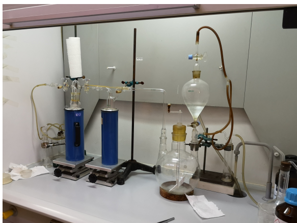
(a) Aparatura za razvijanje CO 2 .
