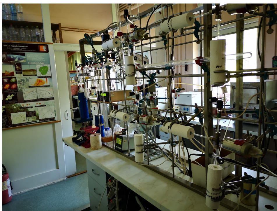
Slika 4.11: Aparatura za pripremu uzorka za AMS.
