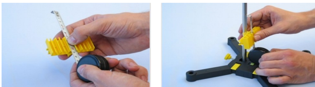
Slika 31. Postavljanje mjerne trake na stalak [22].
