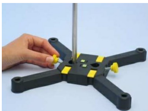
Slika 26. Postavljanje metalne šipke u postolje stalka [21].
