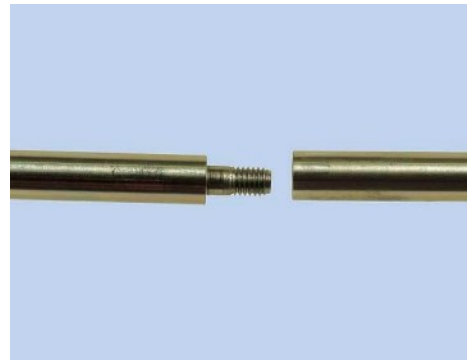
Slika 24. Sastavljanje metalne šipke duljine 60 cm [21].
