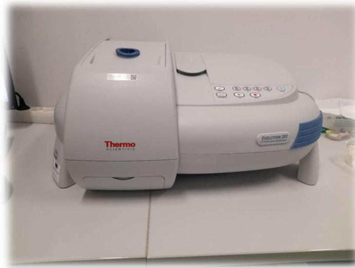
Slika 3.1.5. UV/Vis spektrofotometar (*Thermo Scientific evolution*)
