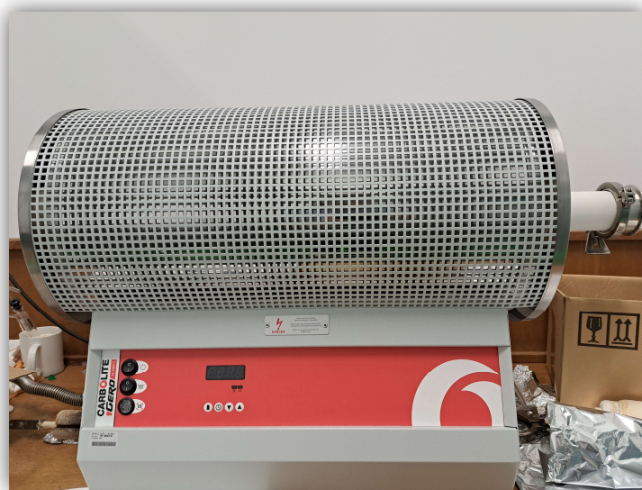
Slika 3.1.6. Peć za sušenje uzoraka ( Carbolite Gero )
