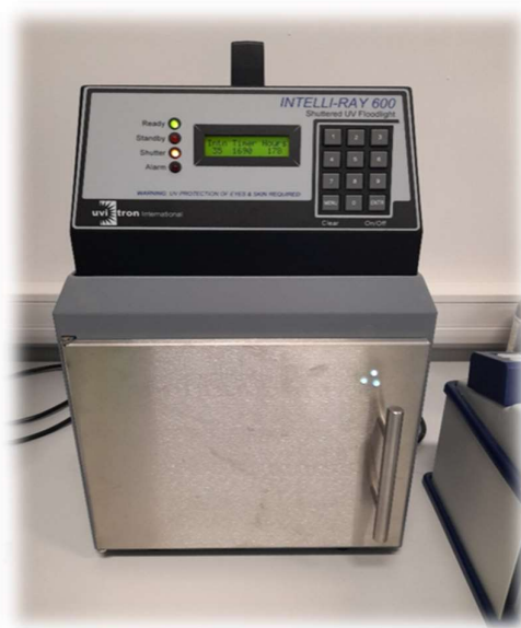
Slika 3.1.4. UV peć ( Intelli-Ray 600 )
