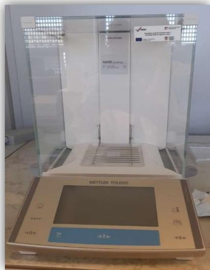
Slika 3.1.1. Analitička vaga (*Mettler Toledo XA 105 Dual Range*)
