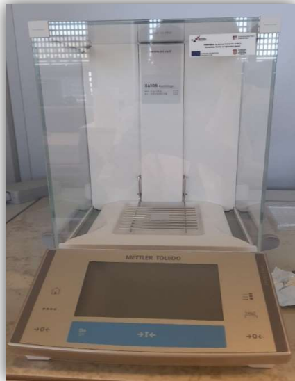
Slika 3.1.1. Analitička vaga ( Mettler Toledo XA 105 Dual Range )
