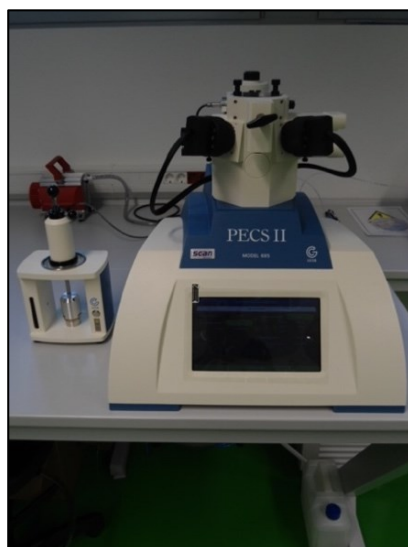
Slika 3.2. Uređaj za naprašivanje (Gatan PECS II Model 685) u sklopu Laboratorija za pretražnu elektronsku mikroskopiju [16]
