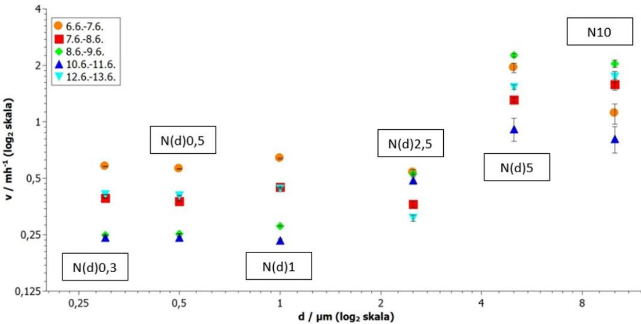
Slika 6.9 Brzine depozicije čestica različitih veličina :  $N(d)0,3$  ( $0,3\text{-}0,5 \mu\text{m}$ ),  $N(d)0,5$  ( $0,5\text{-}1 \mu\text{m}$ ),  $N(d)1$  ( $1\text{-}2,5 \mu\text{m}$ ),  $N(d)2,5$  ( $2,5\text{-}5 \mu\text{m}$ ),  $N(d)5$  ( $5\text{-}10 \mu\text{m}$ ) i  $N10$  ( $>10 \mu\text{m}$ ) i pridružene pogreške brzina depozicije.
