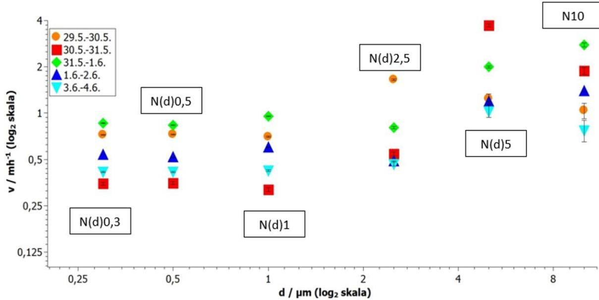
Slika 6.8 Brzine depozicije čestica različitih veličina :  $N(d)0,3$  ( $0,3\text{-}0,5 \mu\text{m}$ ),  $N(d)0,5$  ( $0,5\text{-}1 \mu\text{m}$ ),  $N(d)1$  ( $1\text{-}2,5 \mu\text{m}$ ),  $N(d)2,5$  ( $2,5\text{-}5 \mu\text{m}$ ),  $N(d)5$  ( $5\text{-}10 \mu\text{m}$ ) i  $N10$  ( $>10 \mu\text{m}$ ) i pridružene pogreške brzina depozicije.
