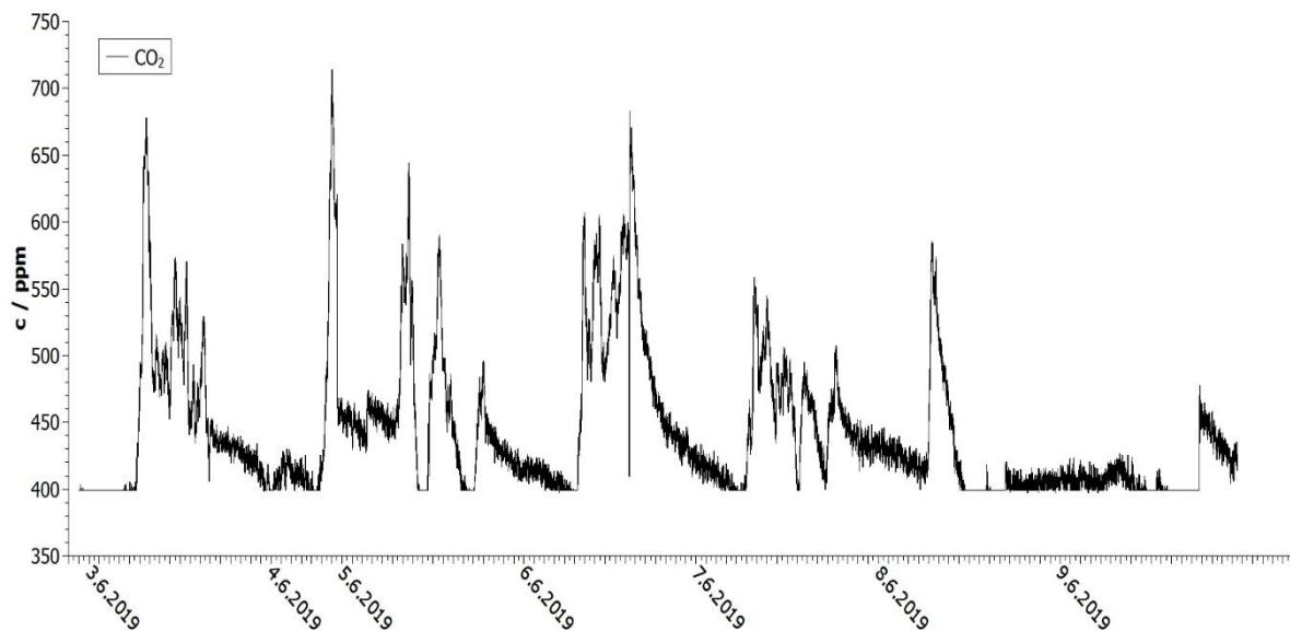
Slika 6.4 Koncentracije  $\text{CO}_2$  u metalnoj radionici u razdoblju od 3.6.2019. do 9.6.2019.
