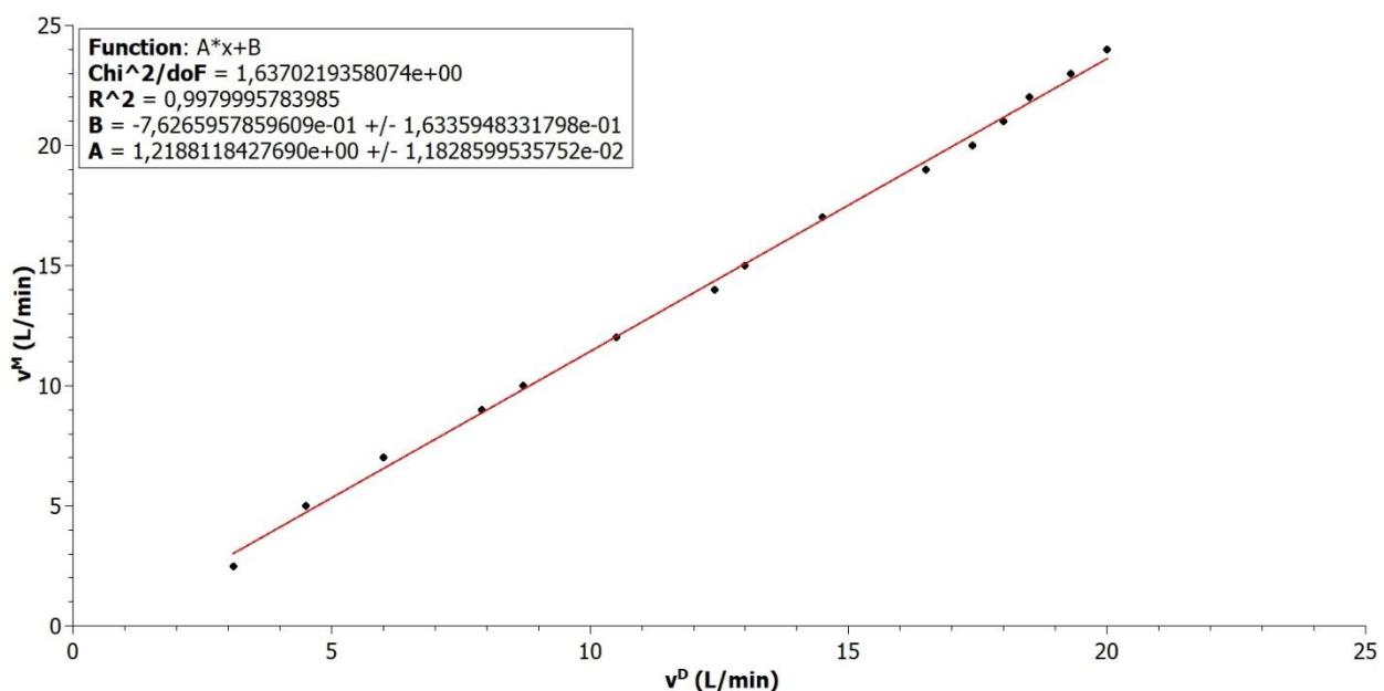
Slika 5.4 Vrijednosti protoka zraka izmjerene na mehaničkom mjeraču u ovisnosti o protocima zraka izmjerenim na digitalnom mjeraču protoka (crne točke) i kalibracijska krivulja mjerena (crveni pravac).
