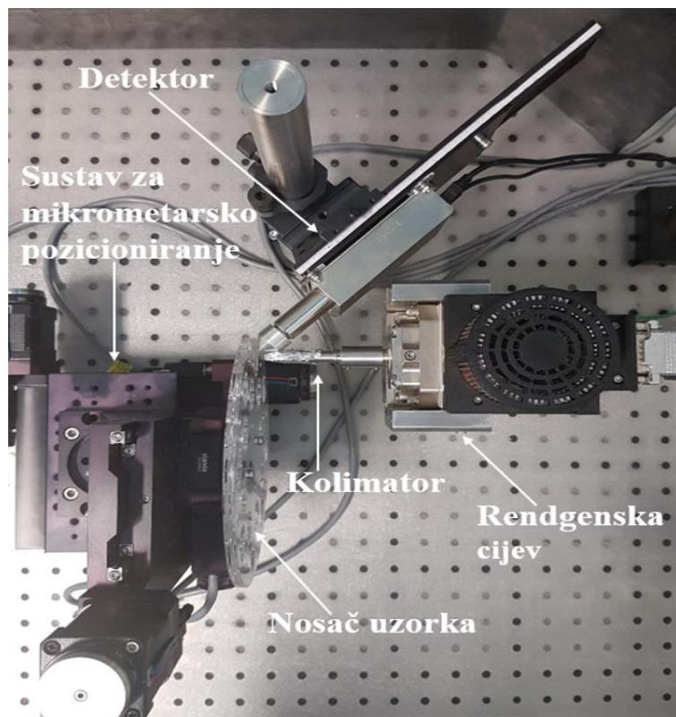
Slika 3.1 Eksperimentalni postav za XRF.
