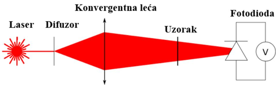
*Slika 5.5 Eksperimentalni postav za određivanje koncentracije crnog ugljika.*
