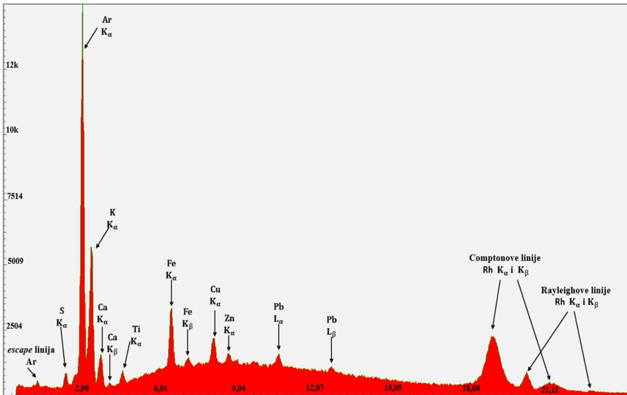
Slika 3.2 Primjer spektra dobivenog XRF tehnikom.
