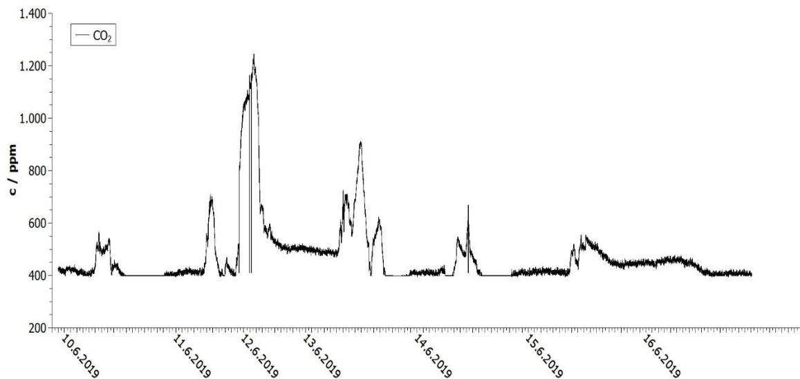
Slika 6.6 Koncentracije  $\text{CO}_2$  u metalnoj radionici u razdoblju od 10.6.2019. do 16.6.2019.
