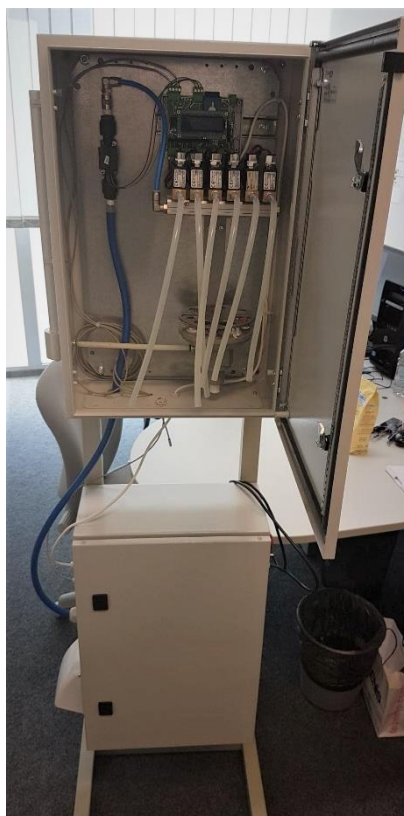
Slika 5.2 Ciklonski uzorkivač lebdećih čestica na Odjelu za fiziku Sveučilišta u Rijeci.
