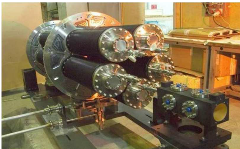
Slika 8: CNGS meta sastavljena je od 5 spremnika. Najniži prima protonski snop, ostala 4 su zamjenska [9].
