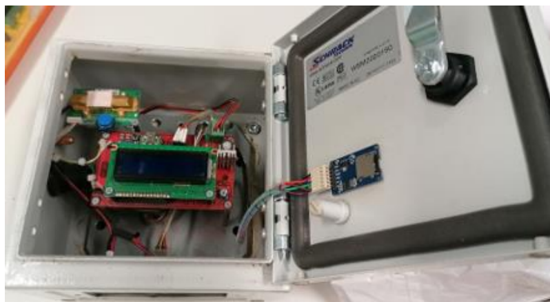
Slika 6. Optički uzorkivač čestica Fakulteta za fiziku Sveučilišta u Rijeci.
