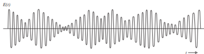
Slika 2.2. Ovisnost električnog polja kvazimonokromatske svjetlosti o vremenu. Kvazimonokromatska svjetlost čini gotovo sinusoidalan poremećaj. (preuzeto iz literature [1])
