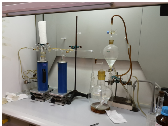
(a) Aparatura za razvijanje CO 2 .
