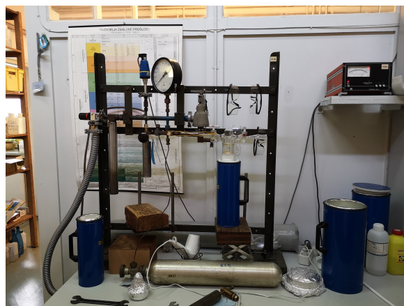
(b) Aparatura za prebacivanje CO 2 .
