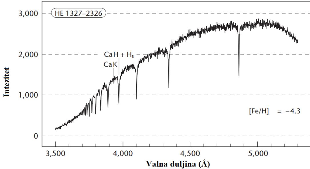
**Slika 2.** Spektar zvijezde HE 1327–2326 iznimno malog metaliciteta, snimljen 2,3 metarskim teleskopom. Vrlo slaba Fraunhoferova K linija kalcija vidi se između vodikovih linijsa na valnoj duljini od oko 390 nm.
