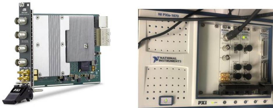
Slika 6.2. Digitalni osciloskop NI PXIe-5160 (lijevo) u kućištu (desno)
