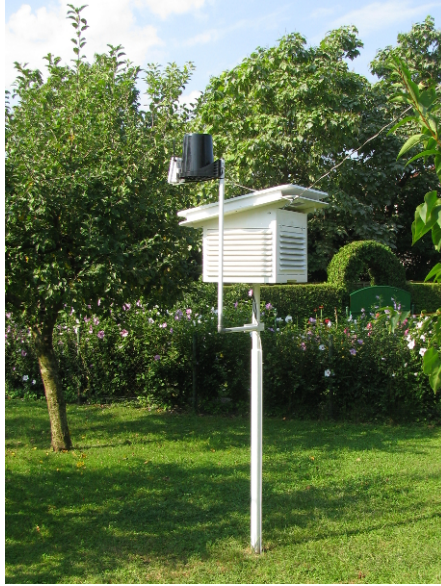
Slika 2.18: Meteorološka kućica za mjerenje temperature zraka [20]
