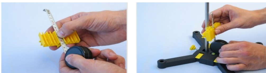
Slika 31. Postavljanje mjerne trake na stalak [22].
