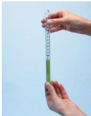
Slika 22. Podešavanje mjerne skale na nulu preokrenutog dinamometra od 2 N [19].
