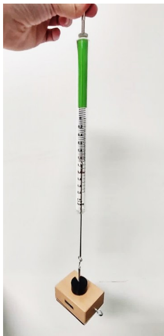
Slika 37. Mjerenje težine drvenog kvadra s metalnom šipkom i utegom od 50 g.
