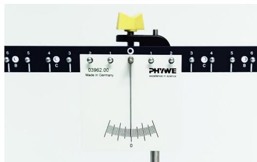
Slika 41. Postavljanje igle i mjerne skale za određivanje ravnoteže poluge.
