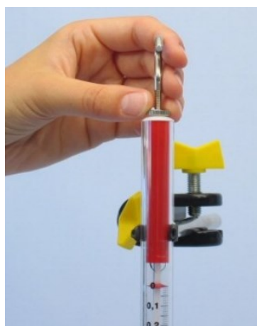
Slika 17. Postavljanje dinamometara na stalak i njihov međusobni položaj [19].
