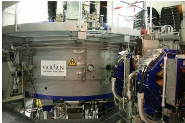
Slika 3.2 Ciklotron Varian koji se koristi u protonskoj terapiji [5]
