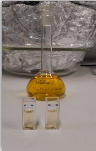
Slika 3.1.3. Uzorci u kvarcnim kivetama i otopina MO
