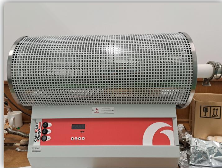
Slika 3.1.6. Peć za sušenje uzoraka (*Carbolite Gero*)
