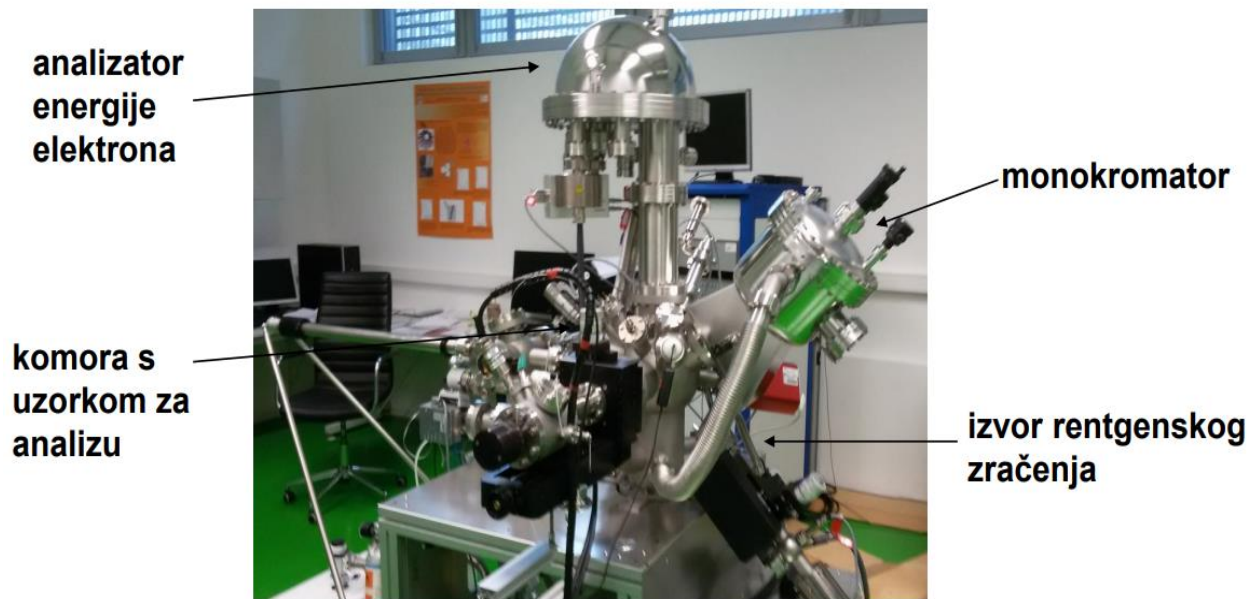
Slika 2.1. Osnovni dijelovi XPS spektrometra [3].
