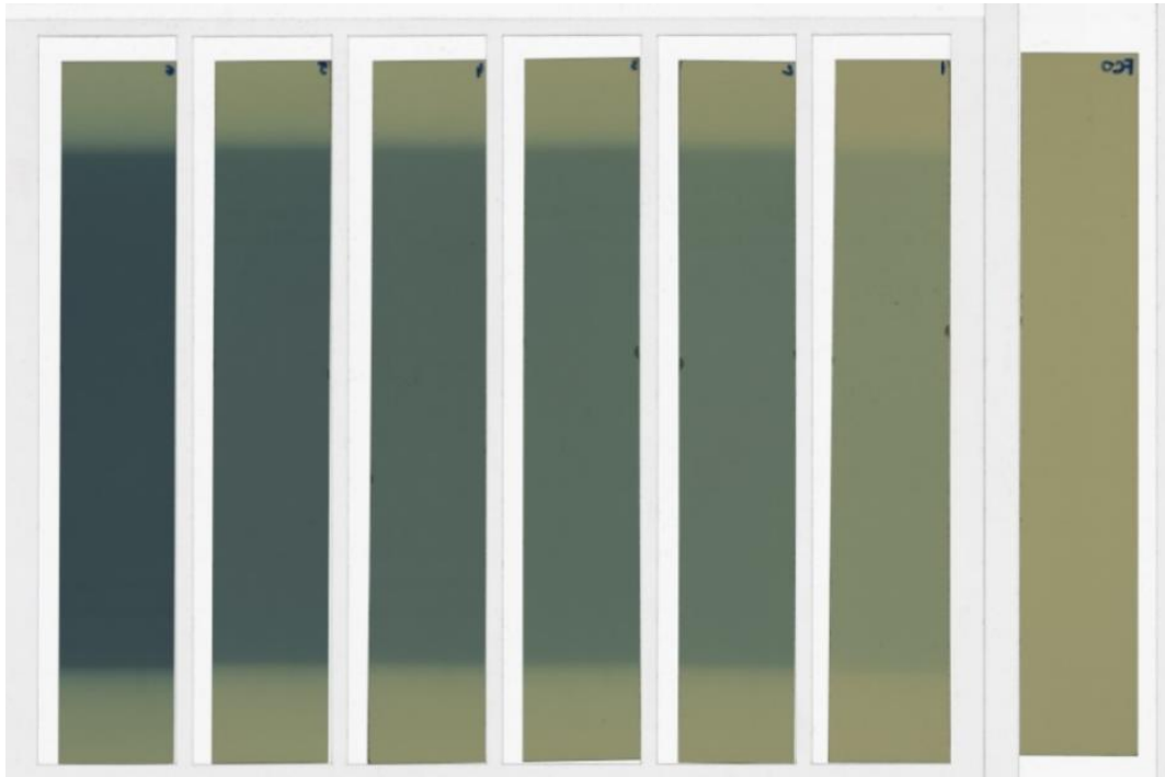
Slika 3.11. Skenirani fregmenti kalibracijskog filma korištenog za kalibracijsku krivulju. Dijelovi filma su ozračeni s apsorbiranom dozom od 6 Gy, 3,5 Gy, 2,5 Gy, 2 Gy, 1,5 Gy i 0,5 Gy, dok je jedan dio bio neozračen.
