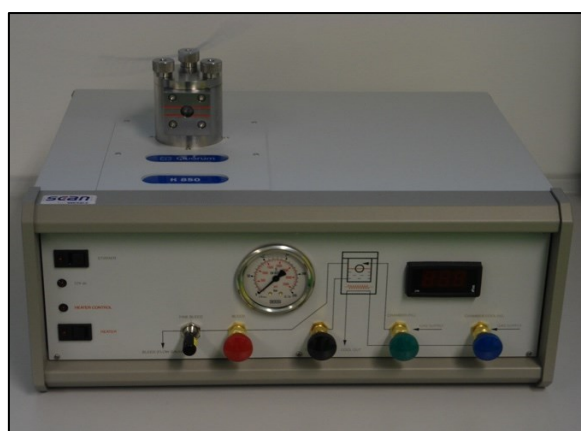
Slika 3.1. Uređaj za sušenje koji radi na principu kritične točke (Quorum K 850) u sklopu Laboratorija za pretražnu elektronsku mikroskopiju [16]
